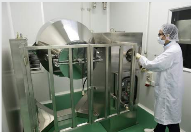
Pencampuran ekstrak herba dengan bahan tambahan menggunakan mesin pengadun
