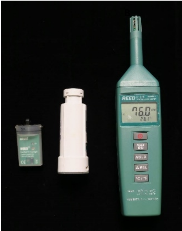
Rajah 1. Alat pengukur iklim mikro. Dari kiri: Perekod data intensiti cahaya, perekod data kelembapan relatif (RH) dan termohigrometer.
