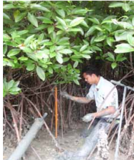
Rajah 2: Pengukuran pin PVC untuk melihat kadar pergerakan lumpur
